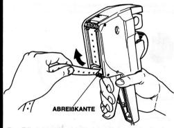
Das Etikettentragband läßt sich auf der Rückseite des Auszeichners durch Druck gegen die **ABREIßKANTE** entfernen.
