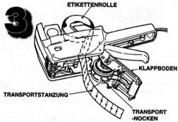
Die Etiketten bis zum Ende des KLAPPBODENS durch das Gehäuse ziehen und die TRANSPORTSTANZUNG in die TRANSPORT-NOCKEN legen.
