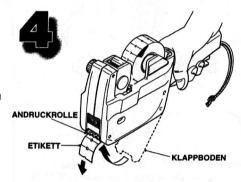
Den KLAPPBODEN schließen bis er einrastet. Den Griff zum Drucken betätigen.
