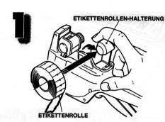
Die ETIKETTENROLLEN-HALTERUNG nach oben ziehen, und die ETIKETTENROLLE inPfeilrichtung einsetzen.
