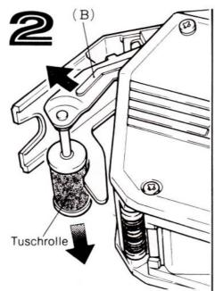
b. Die Tuscherollenhalterung in Richtung (siehe Pfeil B) zur geöffneten Frontabdekkung ziehen. Die Tuscherolle fällt dann aus dem Gerät.
