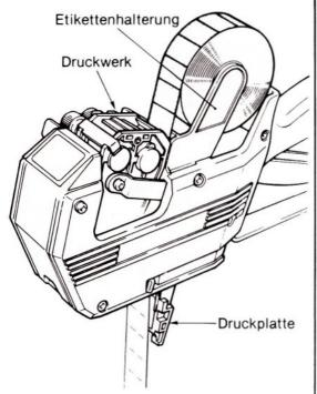
d. Führen Sie das Etikettenband, wie auf der Abbildung ersichtlich, bei halb gedrücktem Griff durch das Gerät. Dann Klappboden verschließen, ohne daß hierbei das Etikettenband seitlich festgeklemmt wird.
