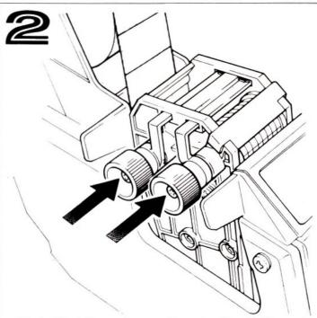
c. Nach Einstellung des gewünschten Druckbildes müssen die Einstellachsen in die Ausgangsposition zurückgedrückt werden (siehe Pfeil).
