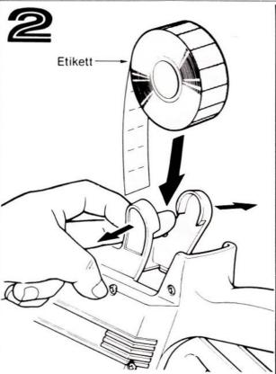
Die Etikettenrollenhalterung etwas auseinanderdrücken und Etikettenrolle so einsetzen, daß diese leicht drehbar ist.
