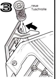
c. Neue Tuscherolle wie auf Skizze ersichtlich in das Gerät einsetzen.
