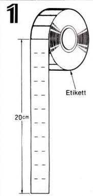
a. Von der Etikettenrolle einen ca. 20 cm langen Etikettenstreifen abrollen. Bei Etiketten mit Sicherheitsstanzung müssen die ersten ca. 15 Etiketten vom Etikettentragband abgelöst werden.
