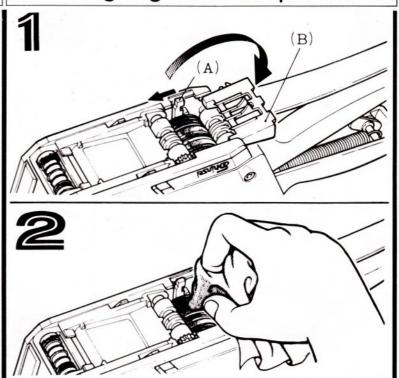
Nach längerem Gebrauch empfiehlt es sich, die Etiketten-Transportwalze von Staub und Kleberesten zu säubern. Die Säuberung gewährleistet einen störungsfreien Etikettenvorschub.
