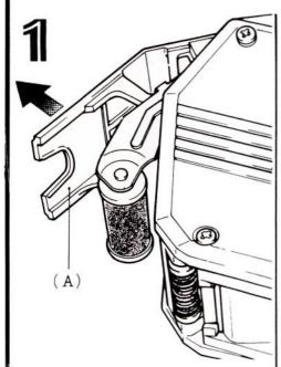
a. Die Frontabdeckung öffnen (A) und das Gerät mit derÖffnung der Tuscherollenhalterung nach unten halten, wie aus Abbildung 1 ersichtlich.
