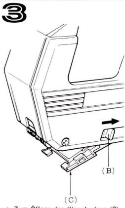
c. Zum Öffnen des Klappbodens (C) die auf beiden Seiten befindlichen Verschlußknöpfe (B) gleichzeitig nach hinten ziehen.
