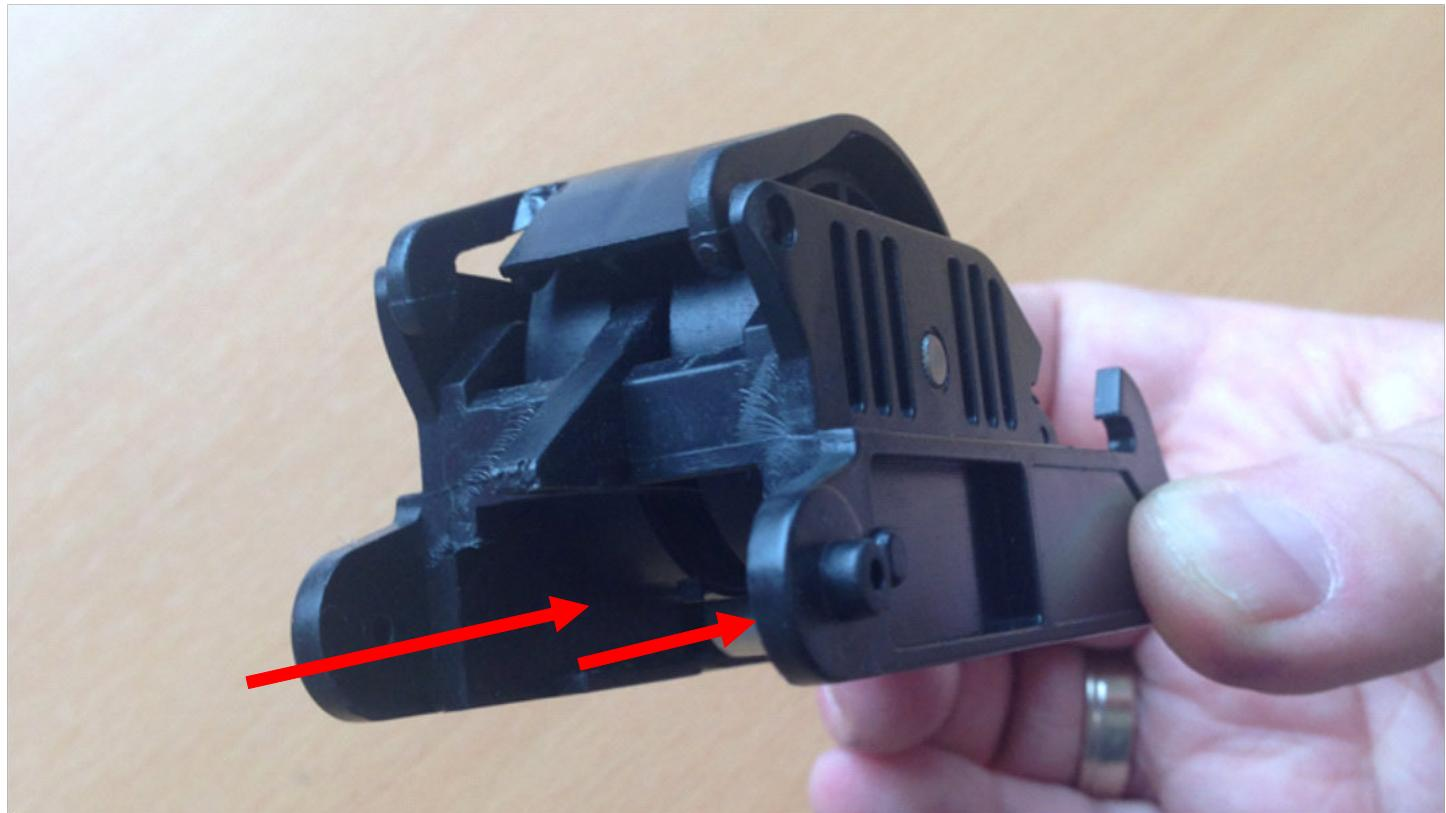
Die beiden Noppen links und rechts (O) sind noch **NICHT** am Gehäuse eingehängt.
