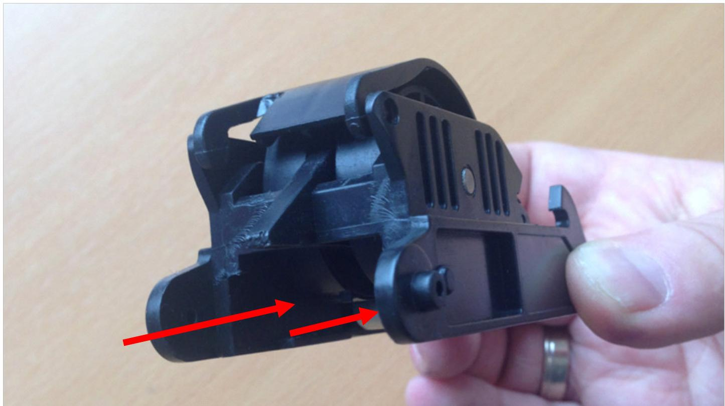
Les deux boutons à gauche et à droitec (0) ne sont **pas encore** accrochés dans le boîtier.
