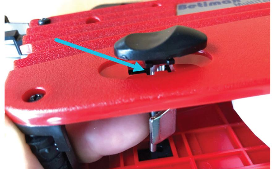
Auf der gegenüberliegenden Seite muss der Entriegelungsschieber ganz nach hinten geschoben werden. Nur so kann der Entriegelungsstift in die Öffnung eingeführt werden.
