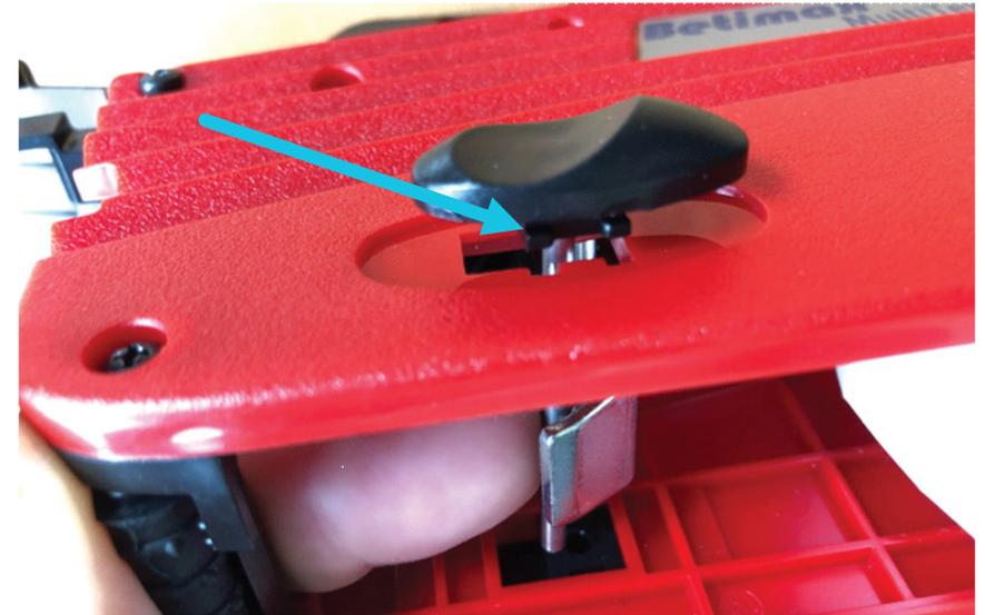
Au côté opposé, la poignée de déverrouillage doit être poussée tout vers l'arrière. Seulement de cette manière la goupille de déverrouillage peut être introduite dans l'ouverture.
