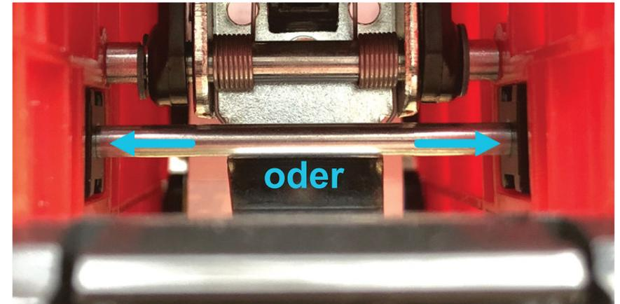
Nun sollten sie den linken oder den rechten Entriegelungsschieber mit dem Entriegelungsstift aus dem Gerät entfernt haben.
