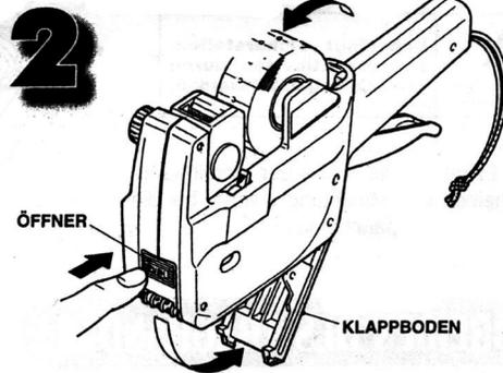
Die Etikettenrollen-Halterung wieder einklappen, auf den **ÖFFNER** drücken, um den **KLAPPBODEN** zu öffnen.
