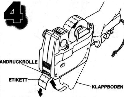
Den **KLAPPBODEN** schließen bis er einrastet. Den Griff zum Drucken betätigen.
