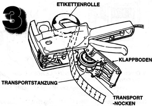
Die Etiketten bis zum Ende des **KLAPPBODENS** durch das Gehäuse ziehen und die **TRANSPORTSTANZUNG** in die **TRANSPORT-NOCKEN** legen.
