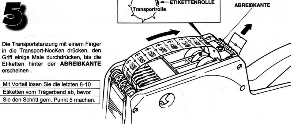
Die Transportstanzung mit einem Finger in die Transport-Nocken drücken, den Griff einige Male durchdrücken, bis die Etiketten hinter der **ABREIBKANTE** erscheinen.
