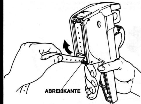
Das Etikettenträgerband läßt sich auf der Rückseite des Auszeichners durch Druck gegen die **ABREIBKANTE** entfernen.
