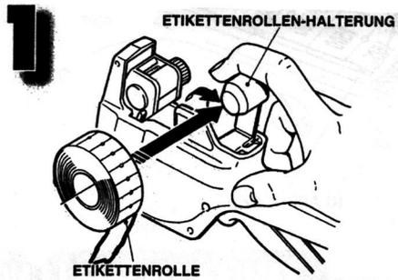
Die **ETIKETTENROLLEN-HALTERUNG** nach oben ziehen, und die **ETIKETTENROLLE** in Pfeilrichtung einsetzen.
