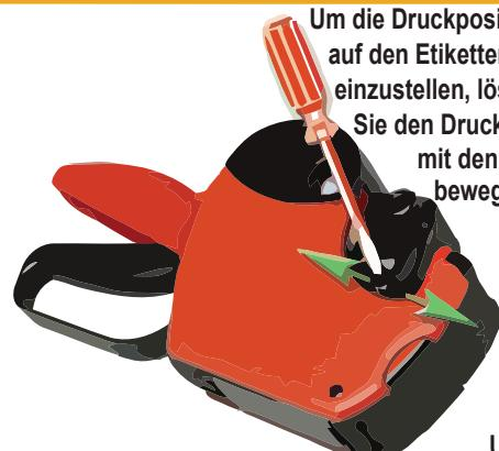
Um die Position des Druckes zu kontrollieren, das Gerät mehrmals betätigen.
