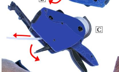
C: Führen sie nun die Etiketten von oben in das Gerät ein, damit des Etikettenband ca. 10cm an der Unterseite heraus hängt.
