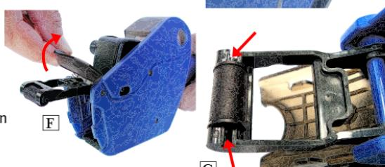
F: Um die Farbrollen zu wechseln, ziehen sie die halbtranspartene Klappe nach vorne. Entfernen sie die alte Farbrolle und ersetzen sie sie mit der neuen.
