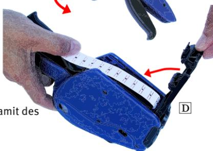
D: Schliessen sie nun zuerst den kleinen und anschliessend den grossen Klappboden. Anchten Sie darauft, dass die Etiketten mittig im Gerät liegen.
