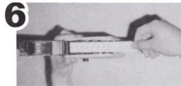
Legen Sie die Etiketten gemäß Abbildung auf Führungsrolle.
