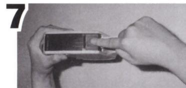
CLOSE THE BASE PLATE COVER TAKING CARE NOT TO DETACH LABEL FROM FEED ROLLER.
