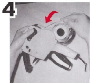
Führen Sie die Etiketten so weit durch das Gerät, dass die Etiketten ca. 10 cm aus dem Gerät herausragen.
